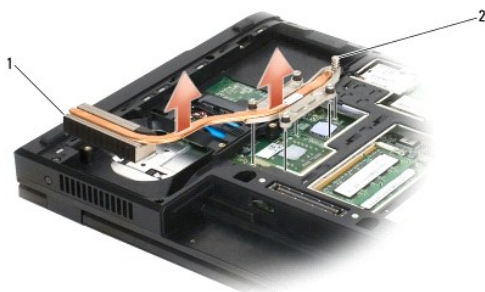
1 radiator procesora model E5500 2 wkręty osadzone (5)
