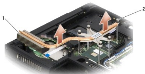
1 radiator procesora model E5400 2 wkręty osadzone (5)
